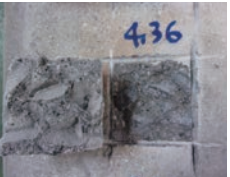
コンクリート破壊状況
